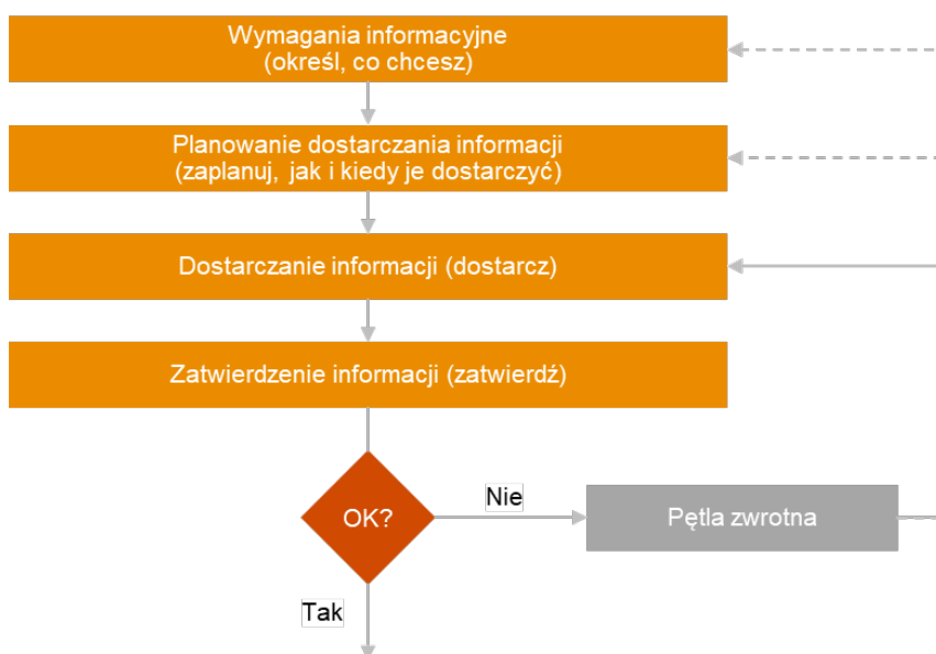
Rysunek 1: Schemat planu zarządzania informacją Źródło: tłumaczenie własne na podstawie [1]
